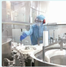
措施 洗瓶机清理爆瓶时：停机，戴护目镜和使用镊子
